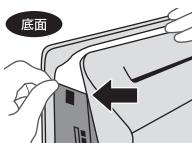
PS5本体を横に倒し、フィルム①の貼り付け位置を確認します。
