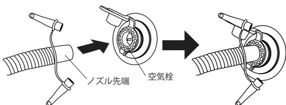
**4** 空気を入れ終わったら、ノズル先端を空気栓から外し、空気栓①を②に差し込んでください。
