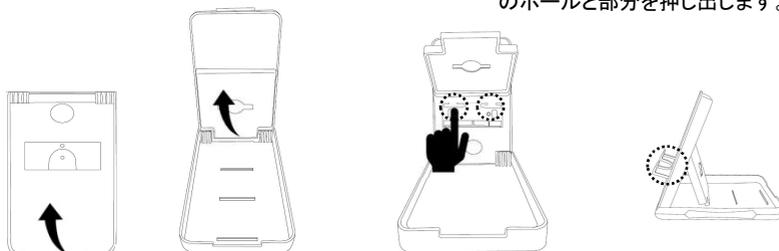
3. スタンドの角度は30/50/60度の3段階に調整することができます。お好みの角度に調整し、SWITCH2本体を設置してください。
