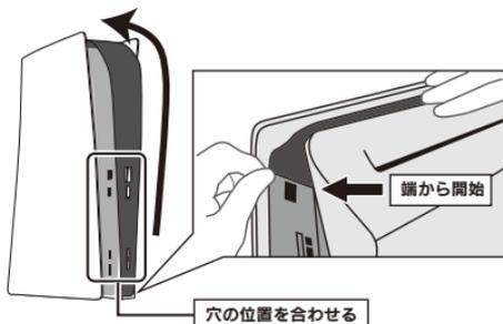
②フィルムの接着面保護シートをゆっくりと剥がしながら、空気が入らないように注意して貼り付けてください。
