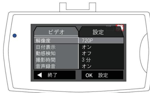
(2) 設定メニューでは“方向ボタン”により項目選択後、“OKボタン”で項目確定します。“メニューボタン”で前に戻ります。設定可能な内容は設定項目を参照ください。
