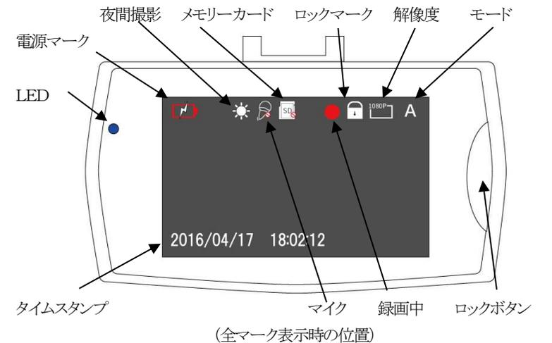
LED ・ 電源 ON で赤点灯します。録画中に青点滅します
